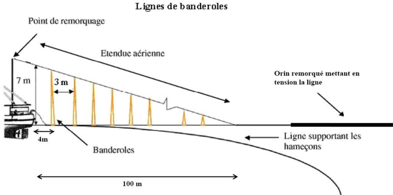
Un minimum de 4 lignes supportant les banderoles doit être suspendu à l'arrière du navire et fixé à une hauteur minimale de 7 mètres au-dessus de l'eau de façon à surplomber directement le point d'immersion des appâts. Les lignes supportant les banderoles doivent être constituées d'un matériau résistant le plus léger possible, d'une longueur minimale de 150 mètres et lestées par un ou des orins à leur extrémité afin de rester hors de l'eau même en cas de vents contraires.
